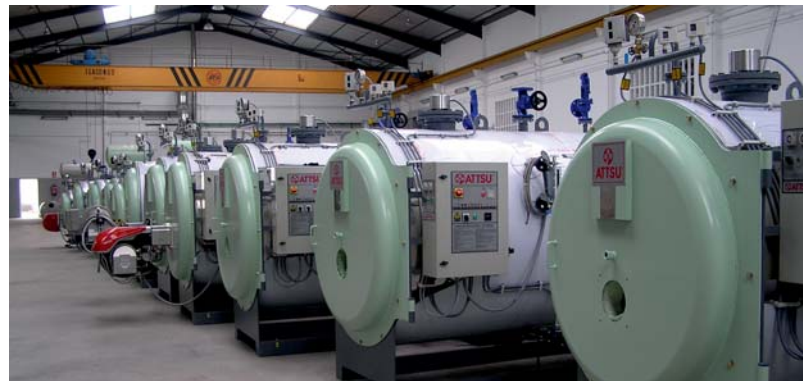
Grupo de caldeiras em linha de montagem.
